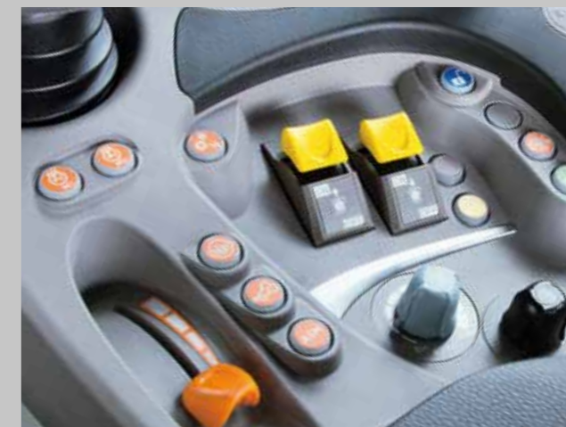
Ovládání vývodových hřídel (přední i zadní) je integrováno do loketní opěrky...
