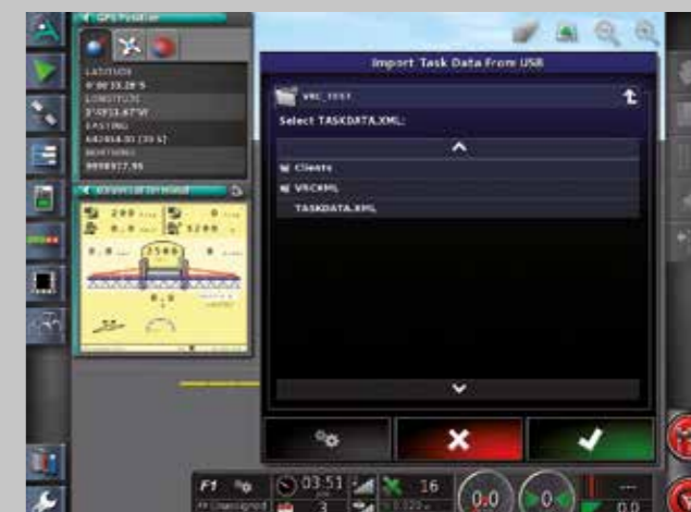
Datový management a výměna dat pomocí formátu ISOXML jsou součástí základní výbavy.
