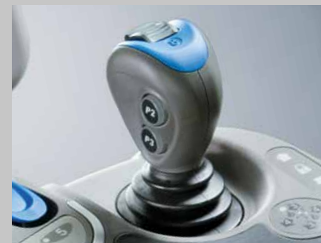
Hydraulické okruhy jsou kromě multifunkční páky ovládány pomocí křížové páky s integrovaným ovladačem pro další okruh.
