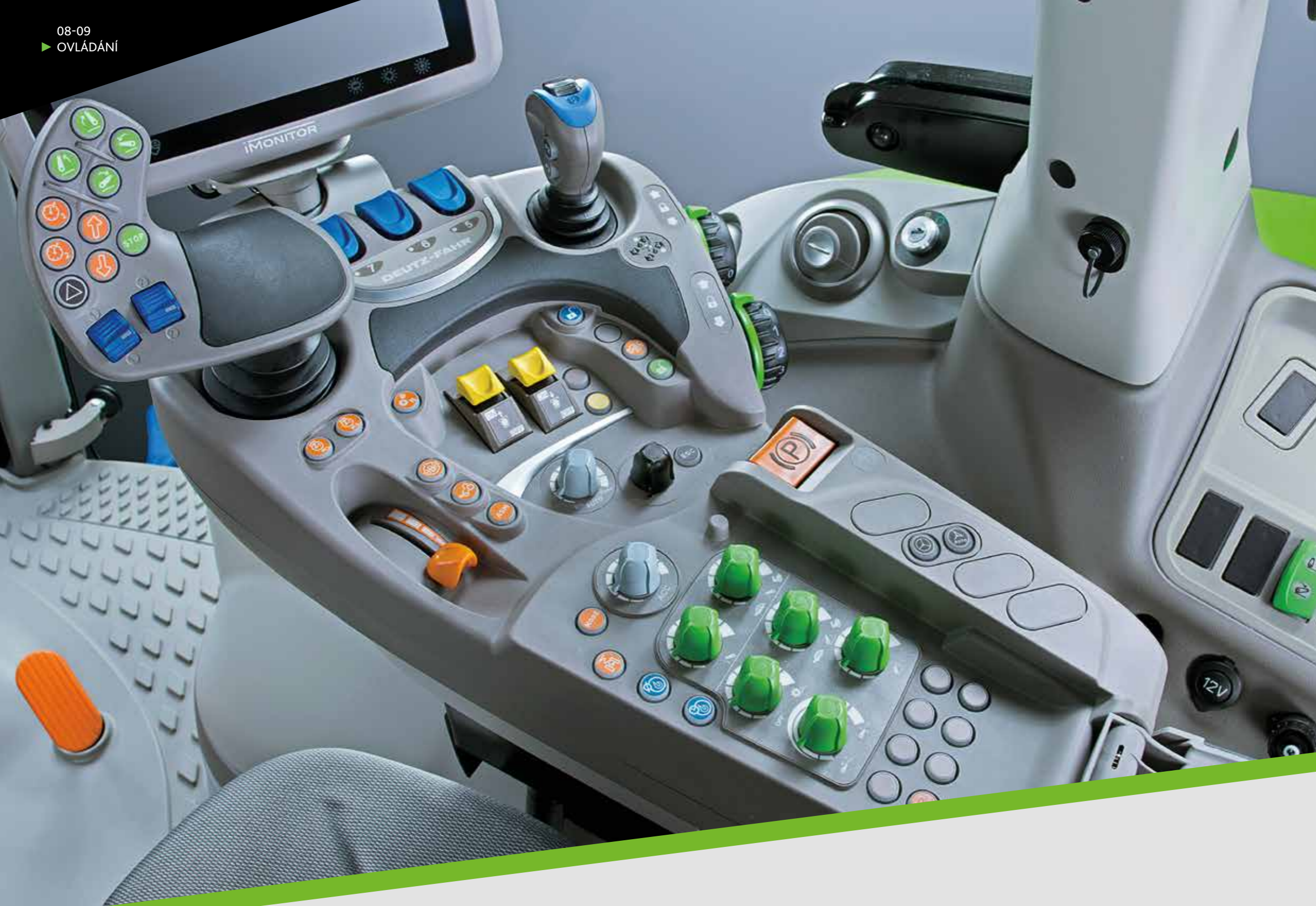
Ovládání vývodových hřídel (přední i zadní) je integrováno do loketní opěrky...
