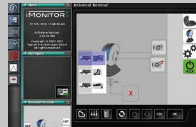
ISOBUS integrace - ovládní připojeného zařízení je možné provádět pomocí traktorových ovladačů.
