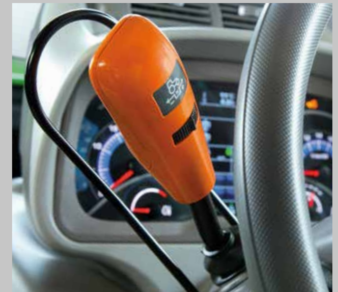
Agresivitu elektrohydraulické reverzace Power Shuttle lze nastavit v 5 stupních prostřednictvím kolečka na reverzační páce.
