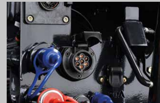
Praktické rozhraní ISOBUS s možností připojení vpředu i vzadu.
