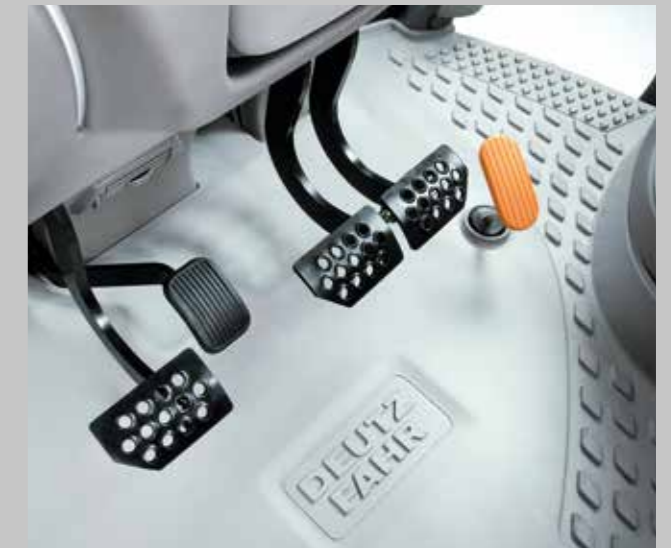
Posilovač brzd garantuje již při lehkém sešlápnutí pedálu dostatek brzdného výkonu.
