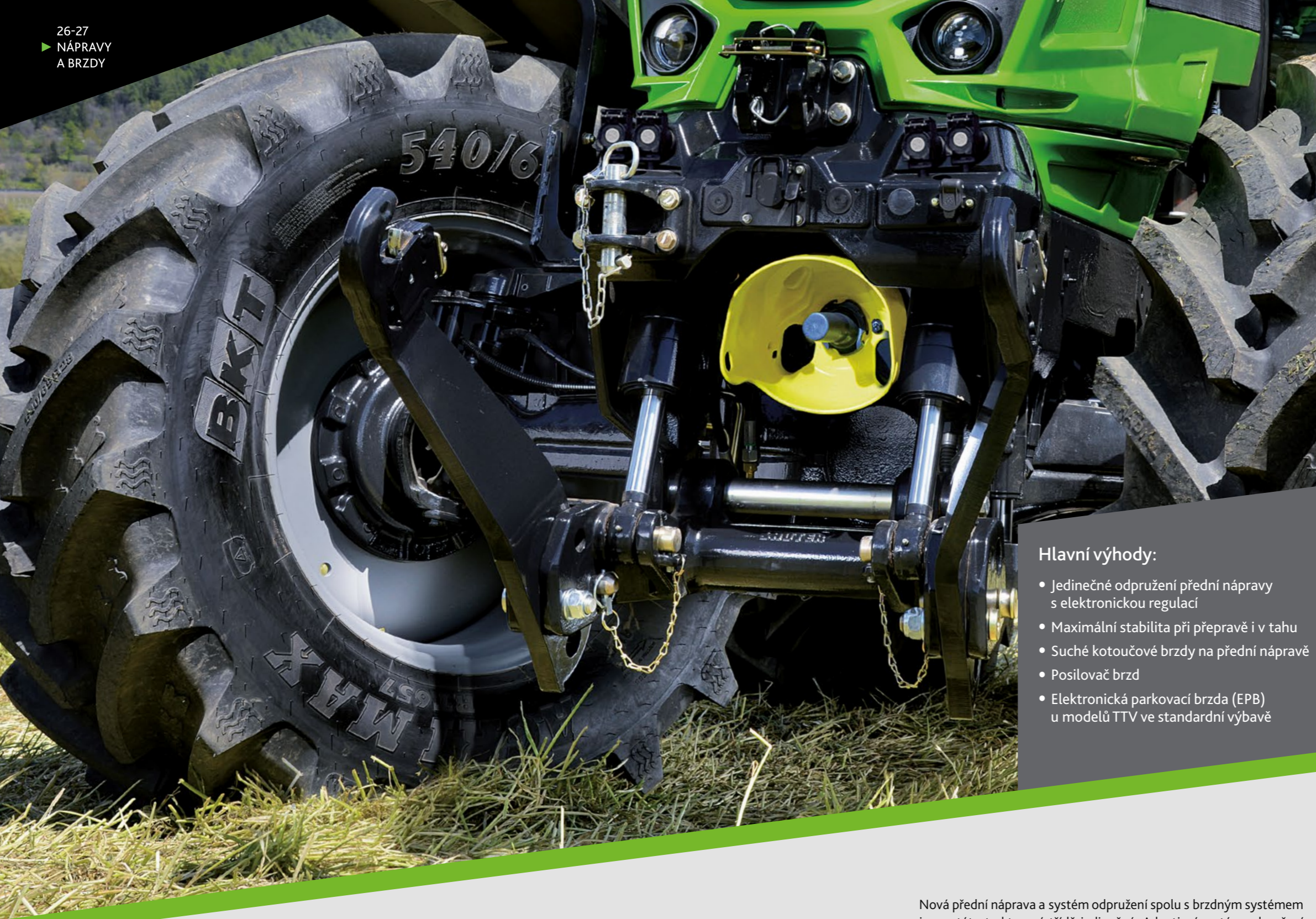
Elektronicky ovládané odpružení přední nápravy se systémem kontroly stability a polohy. Systém odpružení je možné používat jak při přepravě, tak v těžkém tahu. V případě potřeby je možné systém zcela odpojit.
