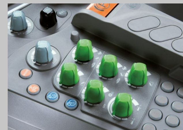
Pokročilá nastavení fungování předního (pouze u modelů TTV) a zadního tříbodového závěsu se provádí jednoduše na potenciometrech umístěných v loketní opěrce.
