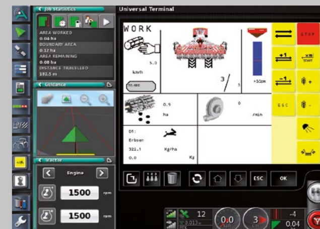
Traktory řady 6 jsou již z výroby připraveny na použití systému TIM (Tractor Implement Management) umožňující automaticky vykonávat pokyny přicházející od připojeného zařízení.
