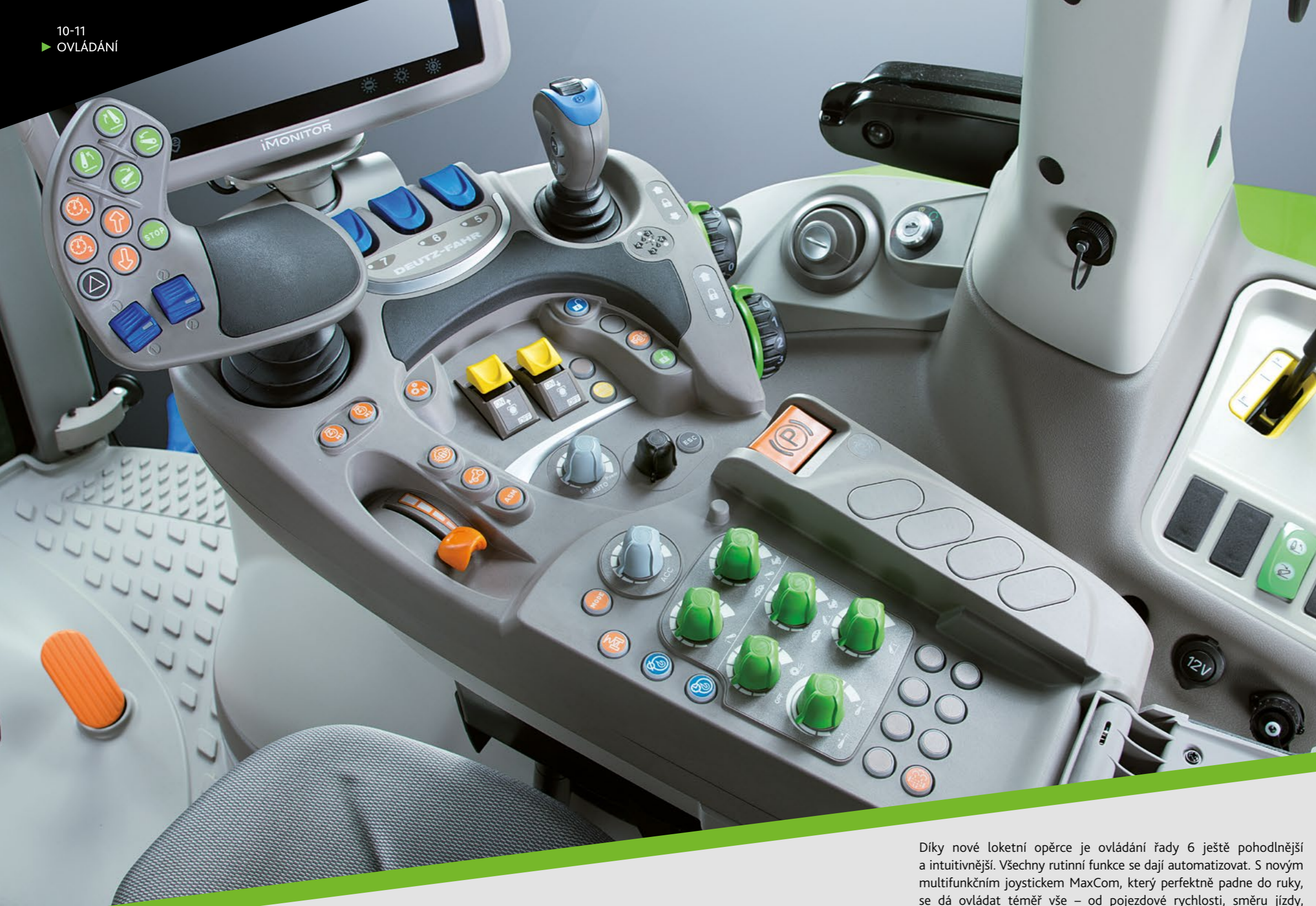
Hydraulické okruhy jsou všechny plně proporcionálně ovladatelné s možností nastavení průtoku a času aktivace. Elektronický joystick je možné naprogramovat pro ovládání čelního nakladače. Další hydraulické okruhy mohou být ovládány pomocí otočného kolečka, které je integrované přímo do elektronického joysticku.
