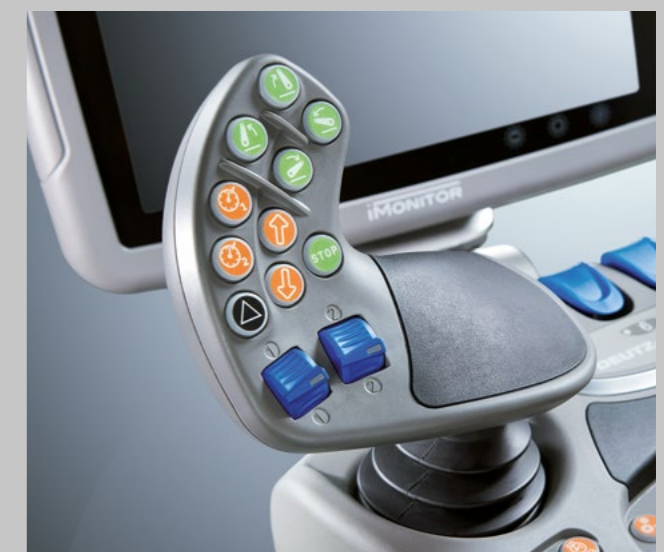
S maximální rychlostí 50 km/h jsou TTV modely řady 6 opravdu profesionální stroje. Pro dosažení vynikajících výsledků si může řidič pomoci dvěma tlačítky na ovládací páce vyvolat až 4 uložené rychlosti a udržovat je na konstantní úrovni.
