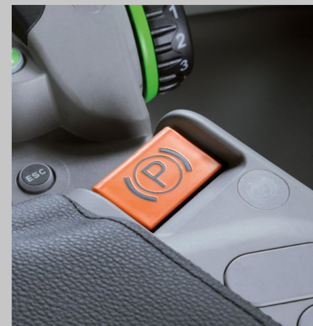
U modelů TTV nahrazuje klasickou ruční brzdou tlačítko EPB, které je napojené přímo na motor ruční brzdy.
