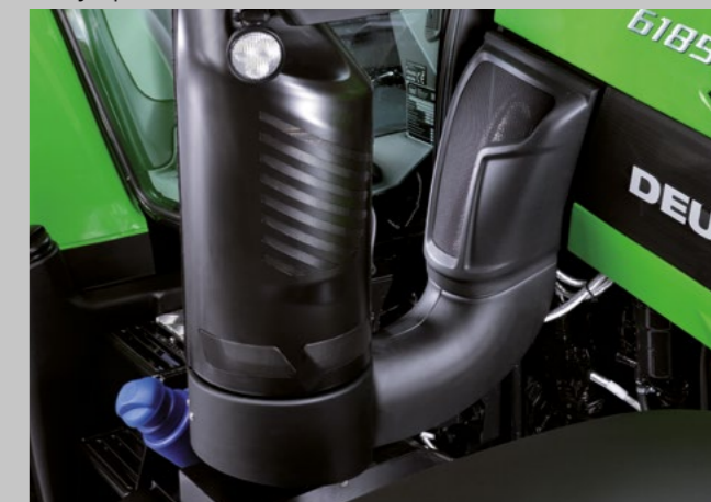
Pasivní filtr pevných částic a systém SCR jsou nejlepším řešením vykazující nízkou spotřebu paliva, ale i celkové provozní náklady.
